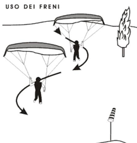
*Figura 6-11. Anche correndo sul prato è possibile pilotare la vela agendo sui freni: è molto utile saggiarne la risposta fin dai primi esercizi.*
