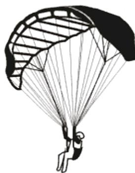
*Figura 6-27. Le "orecchie" consentono un rapido smaltimento di quota in una configurazione relativamente stabile.*
