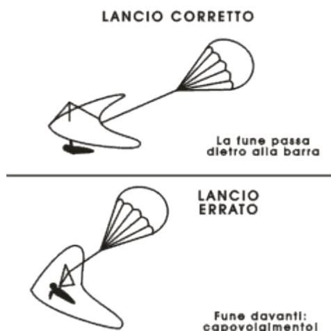
**Figura 5-10.** Il paracadute deve essere lanciato **dietro** la barra di controllo per consentire una discesa regolare.
