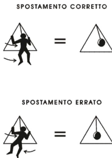
**Figura 5-11.** Per pilotare il deltaplano è necessario spostare il proprio baricentro, il che implica un certo sforzo muscolare. Il deltaplano è unico, tra i mezzi volanti, per il suo particolare sistema di guida a spostamento di peso.
