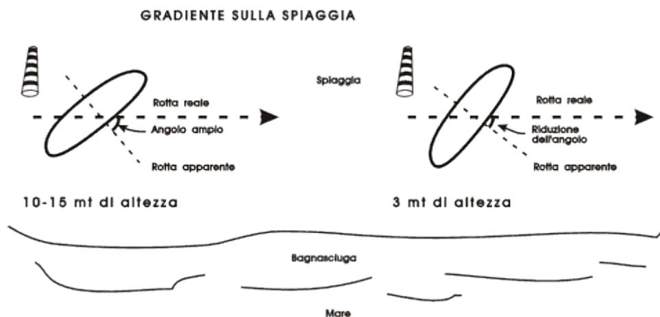
*Figura 6-23. Il gradiente di vento su una spiaggia ha il perverso effetto di "attirare" la vela verso l'acqua: per evitare ciò si deve ridurre l'angolo di deriva man mano che ci si avvicina al suolo.*
