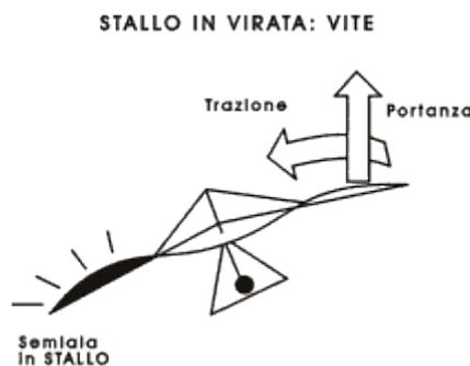
*Figura 5-25. Stallo d'ala (vite) per scarsa velocità in entrata od eccessiva cabrata.*
