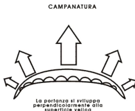
**Figura 6-25.** Effetto della campanatura sulla direzione delle "linee di portanza": si noti l'effetto di mantenere distesa la parte centrale.
