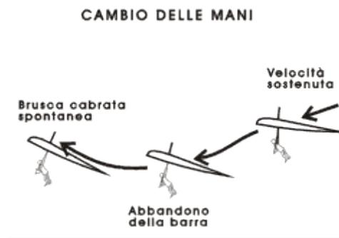
*Figura 5-26. L'abbandono della barra al cambio delle mani genera una improvvisa cabrata: i montanti debbono essere afferrati uno alla volta.*
