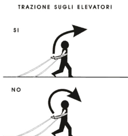
*Figura 6-9. La trazione sugli elevatori deve essere rivolta in avanti ed in alto.*
